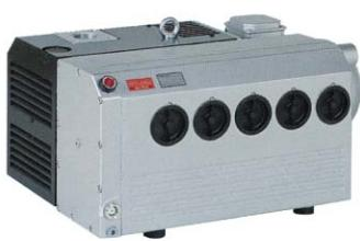
油润滑旋片式真空泵。流量从 202至 303m<sup>3</sup>/hr, 极限真空 0.1 mbar(绝对值)。法兰式电机, 转子两侧装有轴承, 叶片采用铝合金材质, 寿命特长, 吸气口内置网状过滤器和止回阀, 压缩腔内采用O型密封圈。
